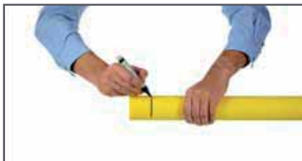
7. Marcar la profundidad de inserción del tubo.
