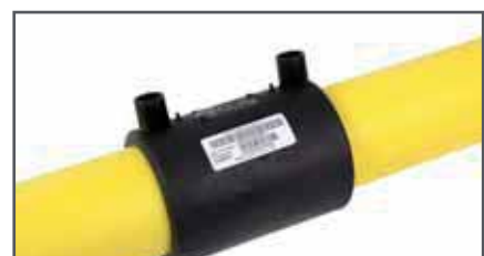
12. Asegurarse de que los testigos de soldadura han subido.
