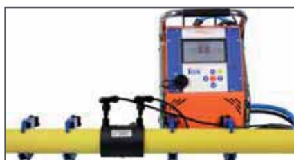
11. Inicio de la soldadura.
